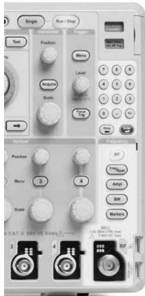
Основные параметры спектра могут быть быстро настроены с помощью специализированных органов управления на передней панели.
