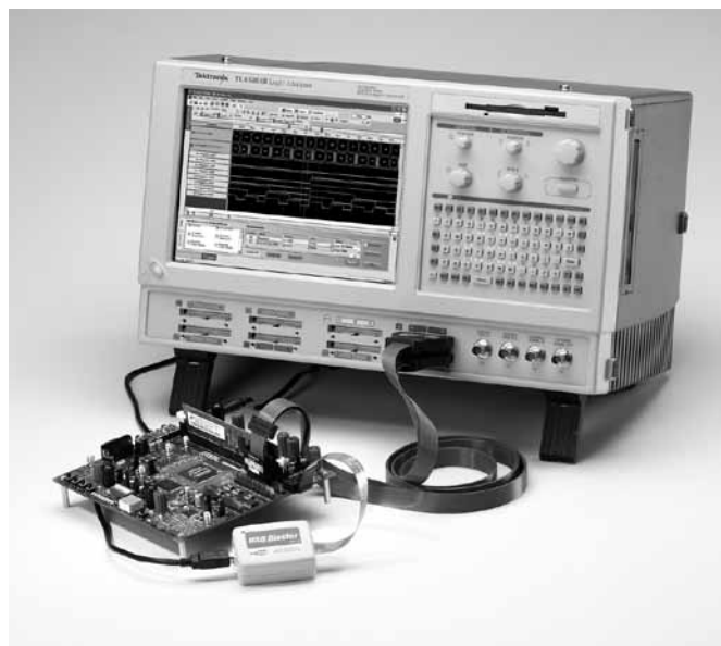
Рис. 2а. Логический анализатор Tektronix TLA5000 соединяется с отлаживаемой схемой двумя кабелями.
