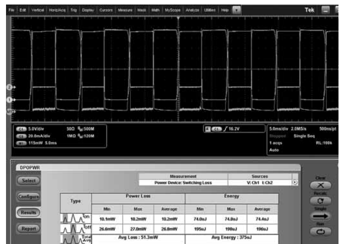
Измерение коммутационных потерь. Автоматические процедуры позволяют быстро и точно выполнять анализ типовых параметров.
