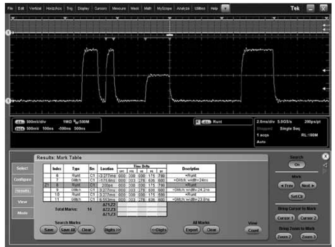
Поиск. Результаты расширенного поиска ранта или кратковременного глитча в длинной записи сигнала. Каждый случай появления ранта или глитча автоматически маркируется, чтобы к нему можно было вернуться в нужное время.
