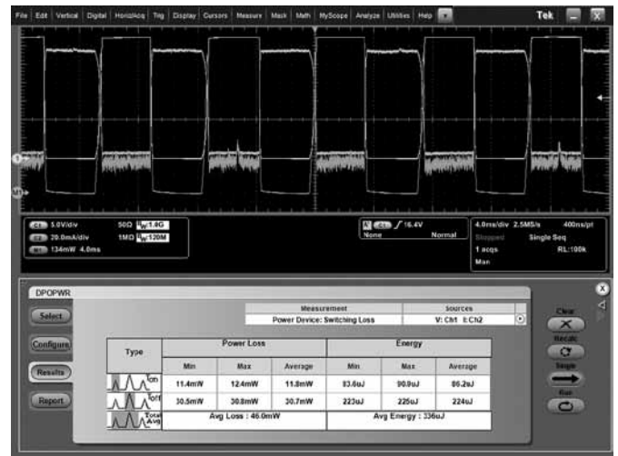
Измерение коммутационных потерь. Автоматический анализ источников питания позволяет быстро и точно выполнять анализ типовых параметров.
