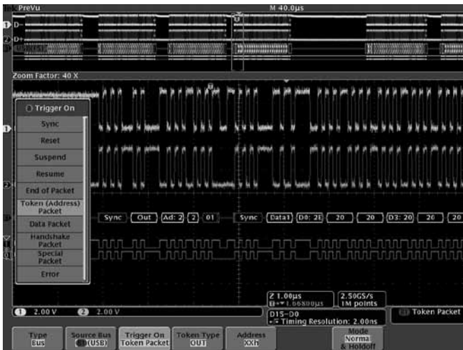
Запуск по конкретному пакету шины USB. Желтая осциллограмма представляет собой сигнал D+, а синяя – D-. Осциллограмма сигнала шины показывает декодированное содержимое пакета, включая Старт, Синхронизацию, Идентификатор пакета, Адрес, Конечную точку, Контрольную сумму, Данные и Стоп.
