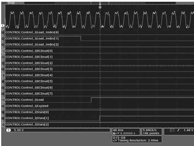
Рис. 8а. Осциллограф смешанных сигналов серии MSO4000 и ПО FPGAView упрощают отладку ПЛИС.
