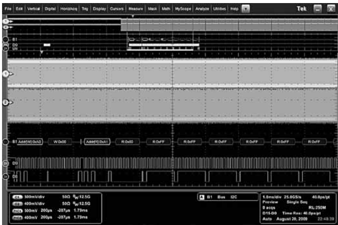
Захват длительностью 10 мс участков синхронных высокоскоростного и низкоскоростного сигналов с частотой дискретизации 25 Гвыб/с.
