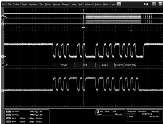
Запуск по пакету OUT Token высокоскоростной последовательной шины USB. Шинное отображение сигнала включает декодированное содержимое пакета, в том числе Start (пуск), Sync (синхронизация), PID, Address (адрес), End Point (конечная точка), CRC, Data values (значения данных) и Stop (стоп).
