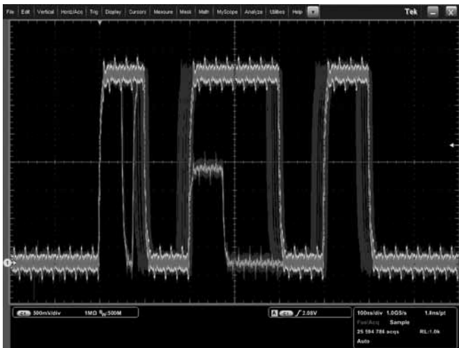
Технология цифрового люминофора в осциллографах серии DPO7000C обеспечивает скорость захвата более 250 000 осциллограмм в секунду и отображение сигналов с градацией цвета в реальном времени.
