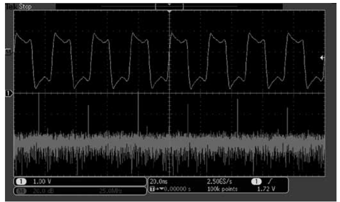
Анализ: быстрое преобразование Фурье импульсных сигналов. Всеобъемлющий набор встроенных средств анализа ускоряет проверку характеристик схемы.
