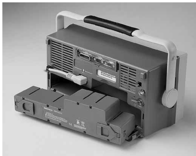
TDS3BATC предоставляет возможность автономной работы от аккумулятора до трех часов.
