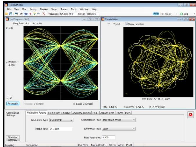
Опция VM07 PDC, ( $\pi/4$  DQPSK, 21 кв/б./с, 800 МГц, 0 дБм, ср.кв. значение EVM: 0,6 %
