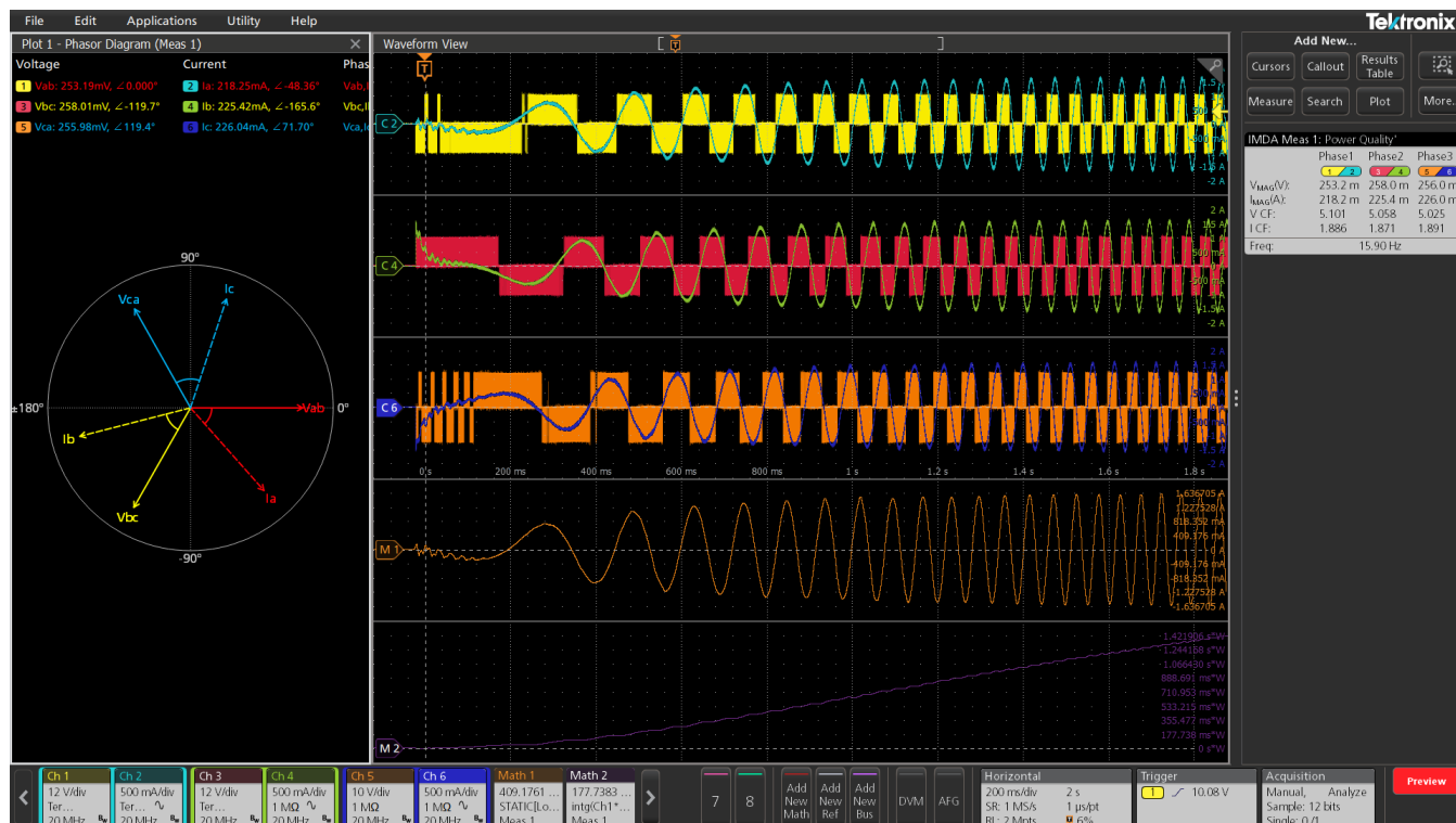
Рис. 31. Слева – векторная диаграмма, отображающая фазу и амплитуду измеренных токов и напряжений трёх фаз питания. В таблице справа показаны все результаты автоматизированных измерений качества питания.
