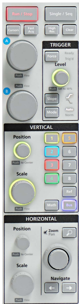
Передняя панель с интуитивно понятными органами управления основными функциями оставляет достаточно места для дисплея высокого разрешения с диагональю massive 15.6" дюймов.
