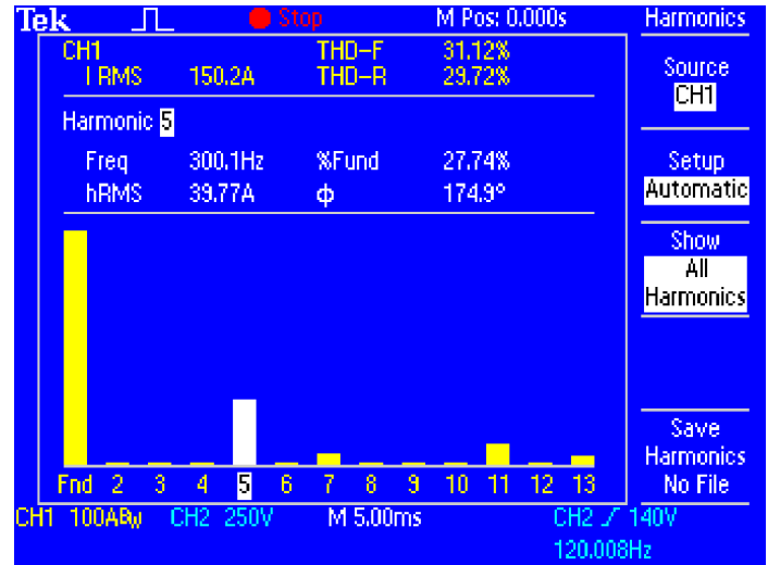
Измерение гармонических искажений с помощью ПО TPS2PWR1.
