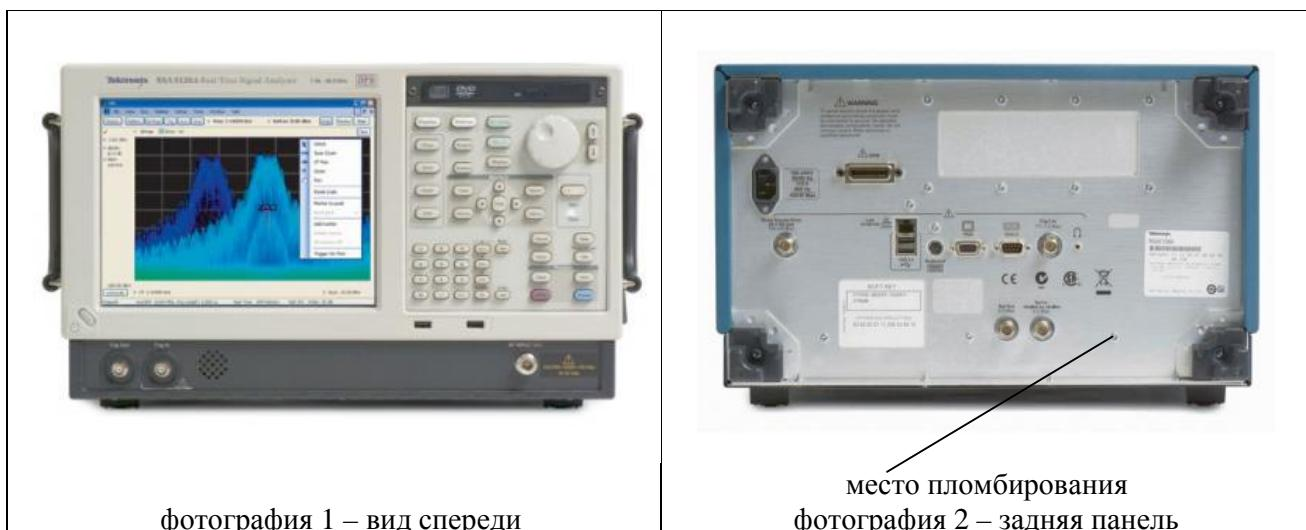
По условиям эксплуатации анализаторы спектра в реальном масштабе времени RSA5115A, RSA5126A соответствуют ГОСТ 22261-94 с рабочим диапазоном температур от 5 до 40 °C.
