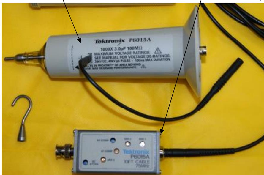
Рисунок 1 – Внешний вид пробника
